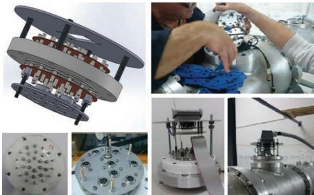
Slika 12: Prilagođenje višekontaktnе epoksidne ploče za prenos električnih signala sa pretvarača iz modela VN prekidača
