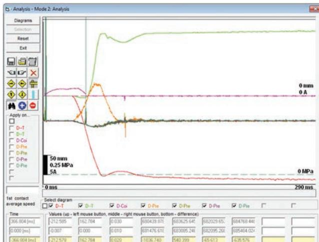
Slika 15: Rezultati mjerjenja na modelu VN prekidača. Osim mjerjenja pritiska prikazani su i hodogrami kretanja kontaktata i struja špule isklopa (Dispozicija senzora kao na Slici 1)
