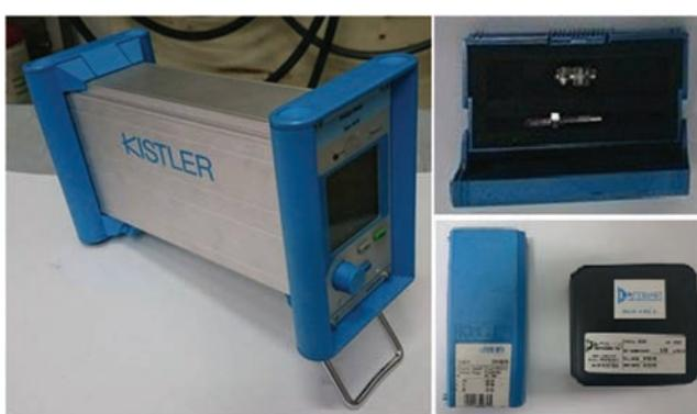
Slika 2: Kistler i Dytran piezoelektrični senzori pritiska (Type 601A odnosno 2200C4) s pripadajućim pojačalom (Charge meter Type 5015A)
