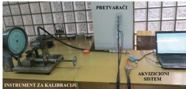
Slika 7: Postavka instrumenta za kalibraciju pretvarača pritiska
