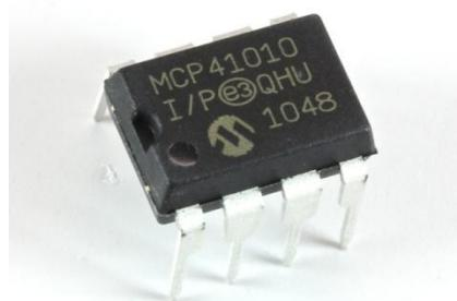
*Slika 5.14. Digitalni potenciometar*
