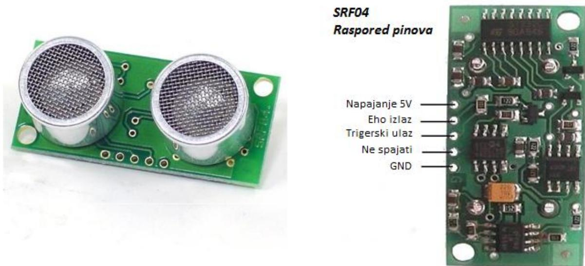
*Slika 4.3. Sklop za kondicioniranje signala SRF04 [7]*
