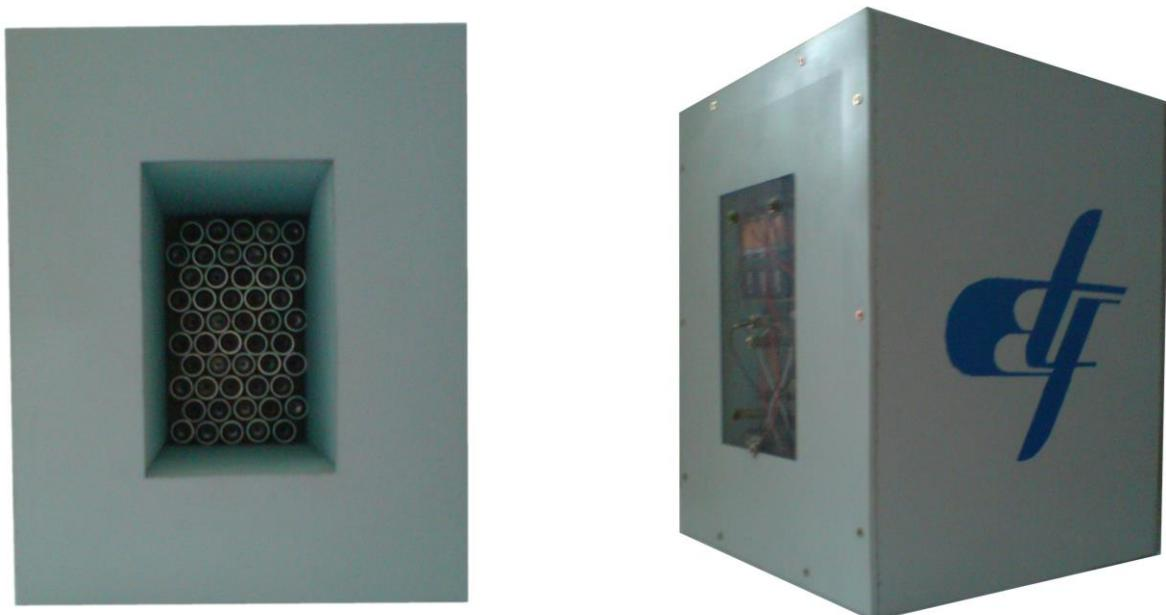
*Slika 8.6. Ultrazvučni usmjereni zvučnik*
