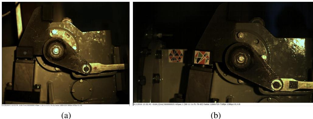
**Slika 6.9:** Prikaz modela VN prekidača čije se kretanje prati. (a) Isječak sa video zapisa na kom je prikazan isklop. (b) Isječak sa video zapisa na kom je prikazan uklop.
