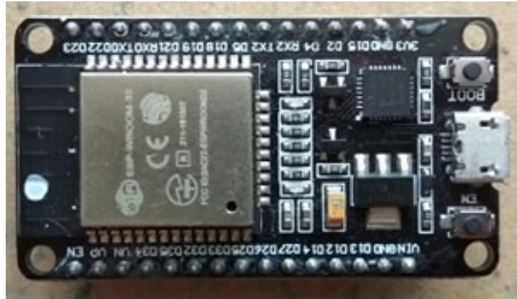
Slika 2.10: Fizički izgled ESP32-DevKitC razvojne ploče
