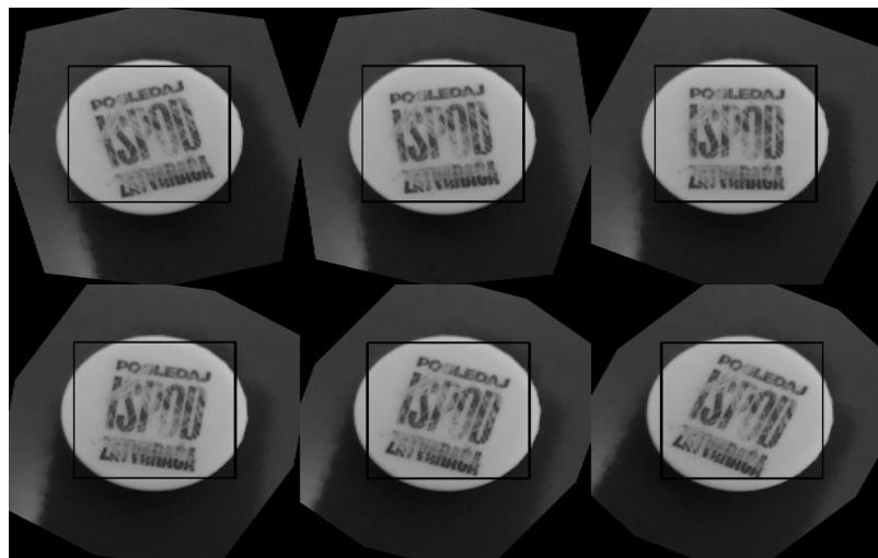
Slika A.26: Sedmi stepen oštećenja, rotirani čepovi, osvjetljenost umanjena za 10
