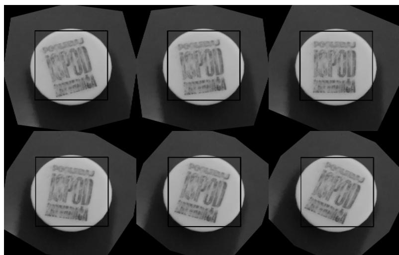
Slika A.27: Osmi stepen oštećenja, rotirani čepovi, osvjetljenost umanjena za 10
