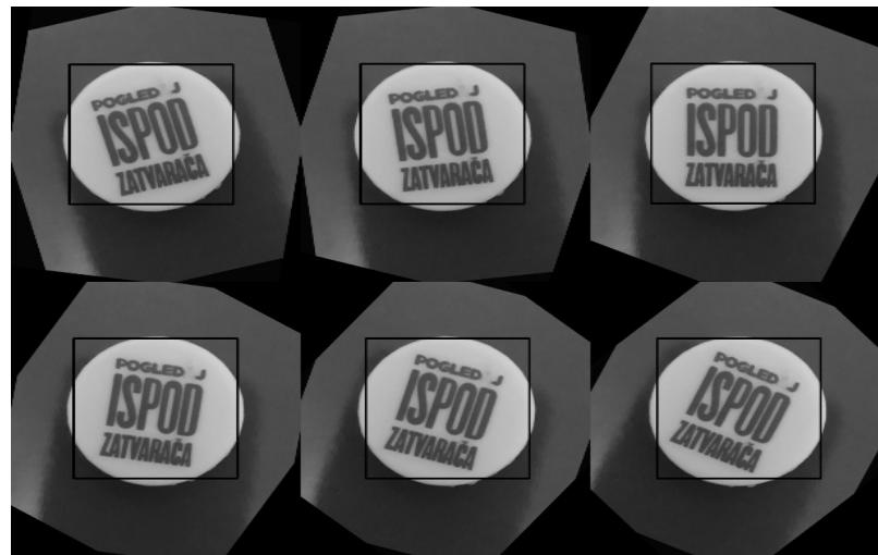
Slika A.11: Prvi stepen oštećenja, rotirani čepovi, osvjetljenje uvećano za 5
