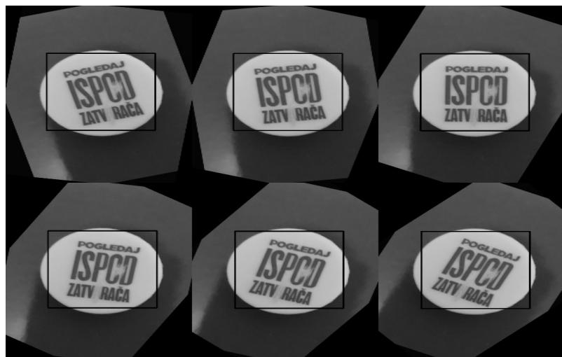
Slika A.13: Treći stepen oštećenja, rotirani čepovi, osvjetljenje uvećano za 5
