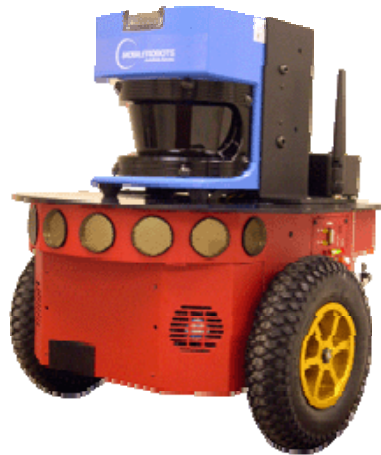
Robot sa diferencijalnim pogonom
