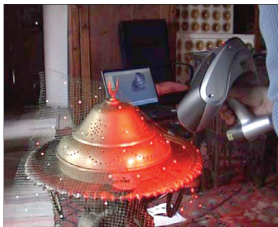
SLIKA 6.11. Skeniranje mangale skenerom ZScanner 700
