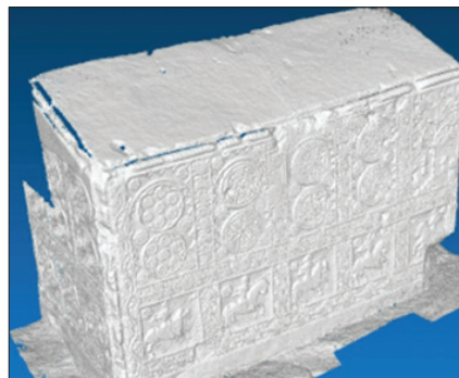
SLIKA 6.8. Polovina stećka kreirana iz dijelova spojenih u Stitcher-u
