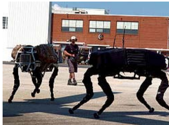
Par BiGDog mobilnih robota sposobnih da se kreću po ledu i nose velike terete do 154 kg.
